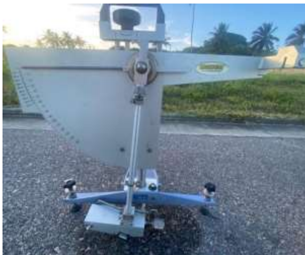
Figura 32 – Ajuste do zero do Pêndulo Britânico
