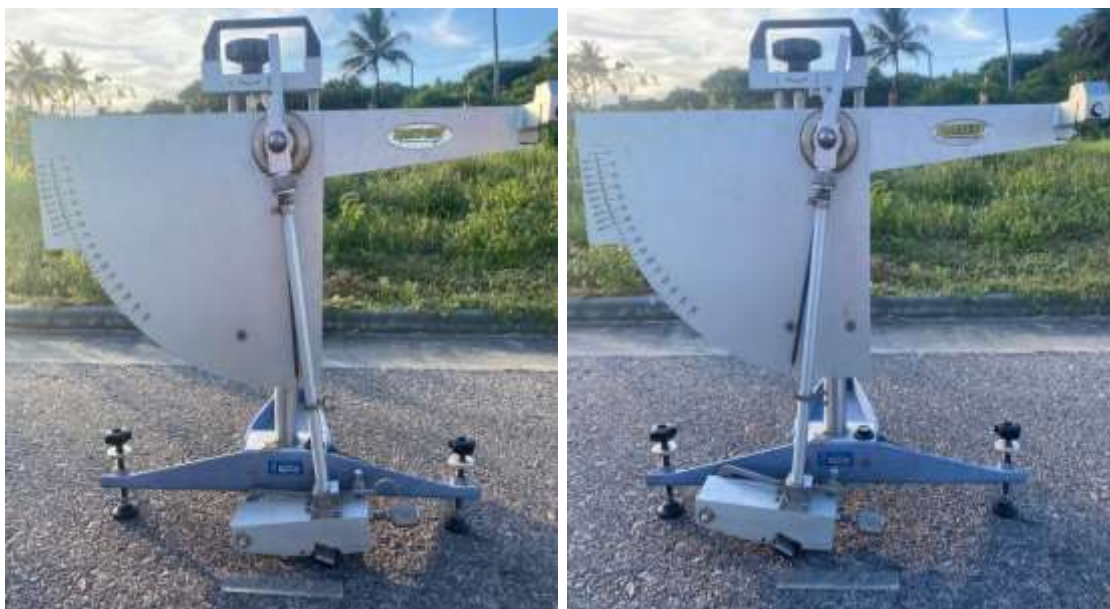
Figura 33 – Ajuste do comprimento do slide do Pêndulo Britânico
