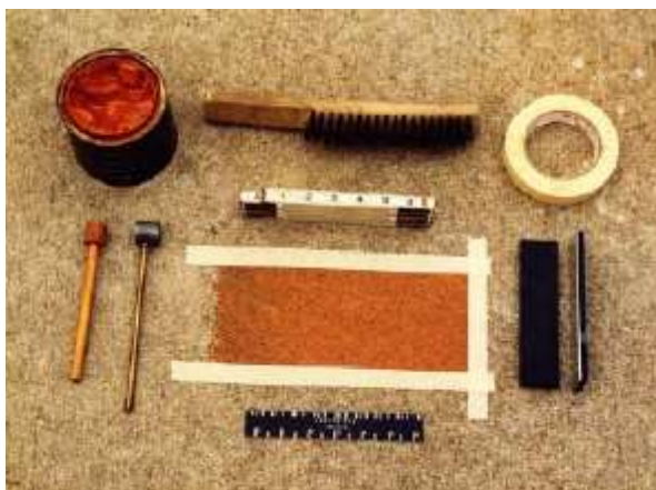
Figura 3 - Aparatos utilizados para realização do ensaio de mancha de graxa
