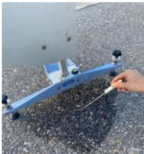
Figura 35 – Medição da temperatura do pavimento
