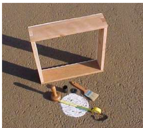
Figura 2 - Aparato utilizado para realização do ensaio de mancha de areia.
