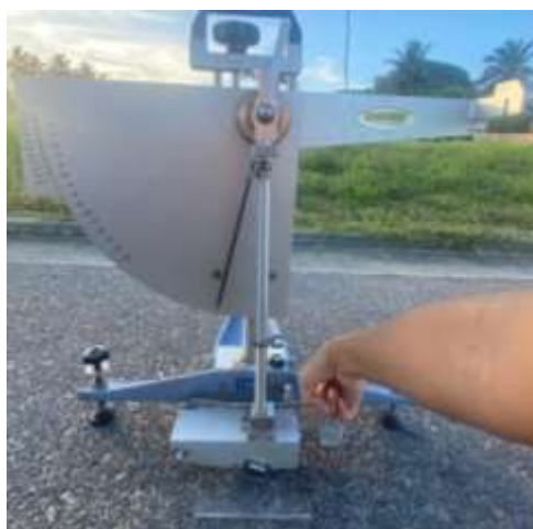
Figura 36 – Levantamento da alça do Pêndulo Britânico
