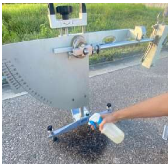
Figura 34 – Aplicação de água até o pavimento ficar drenando
