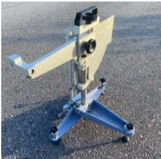
Figura 31 – Parafusos calantes do Pêndulo Britânico
