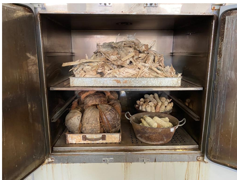
Figura 3 - Resíduos de casca de coco, sabugo de milho e bagaço de cana-de-açúcar em estufa para secagem artificial.
