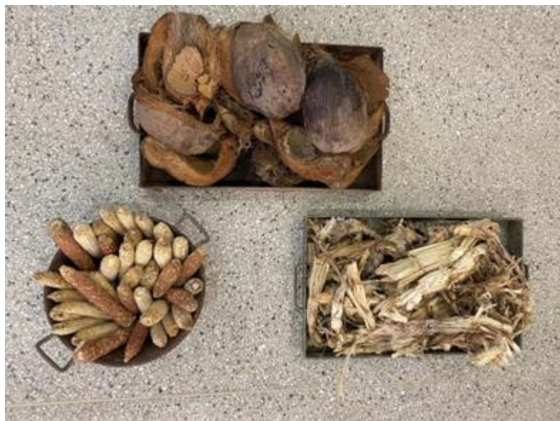
Figura 2 - Resíduos de casca de coco, sabugo de milho e bagaço de cana-de-açúcar colocados em formas metálicas para secagem natural.
