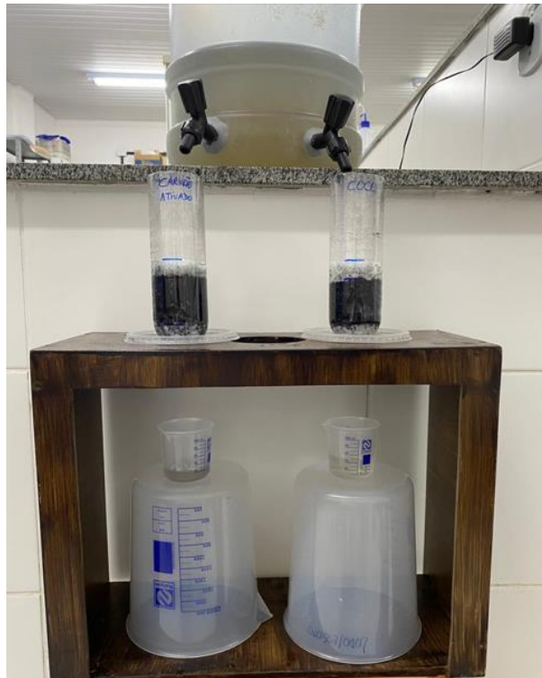
Figura 16 - Sistema filtrante construído.
