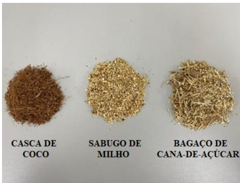
Figura 5 - Amostra dos materiais peneirados na peneira de abertura de malha de 2 mm.
