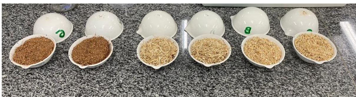
Figura 7 - Biomassas colocadas nos cadinhos para carbonização.
