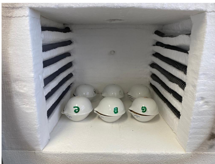
Figura 8 - Cadinhos colocados na mufla para o processo de pirólise.
