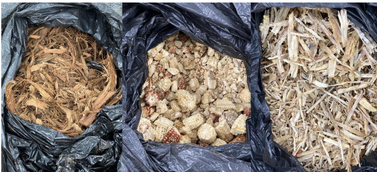
Figura 4 - Materiais triturados no moinho de facas.
