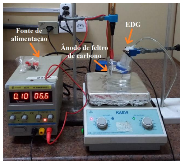
Figura 7: Tratamento dos eletrodos previamente aos ensaios de (bio)degradação. Condições: 250 \text{ mL} de solução aquosa de \text{H}_2\text{SO}_4 em concentração 0,05 \text{ mol L}^{-1} , densidade de corrente de 33,3 \text{ mA cm}^{-2} , t = 180 \text{ min} .
