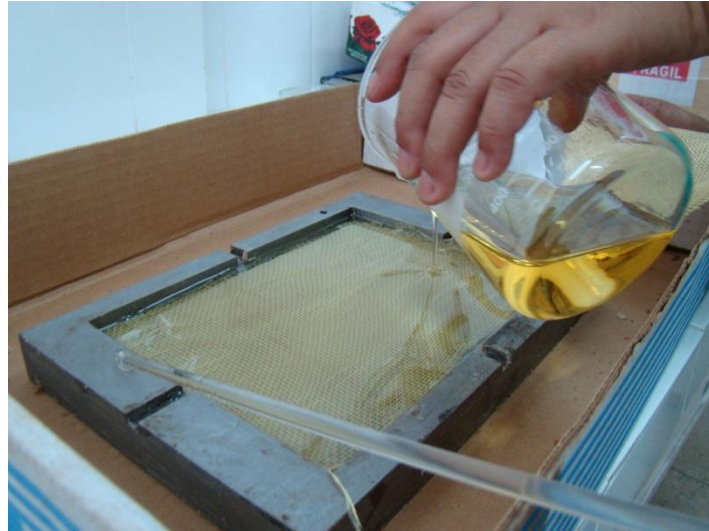
Figura 14 - Manufatura do compósito.
