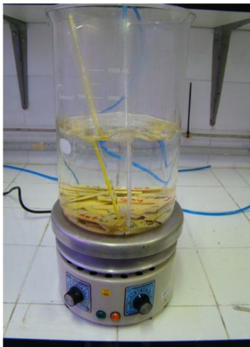
Figura 21 - Corpos de prova imersos em água do mar a 70 °C.
