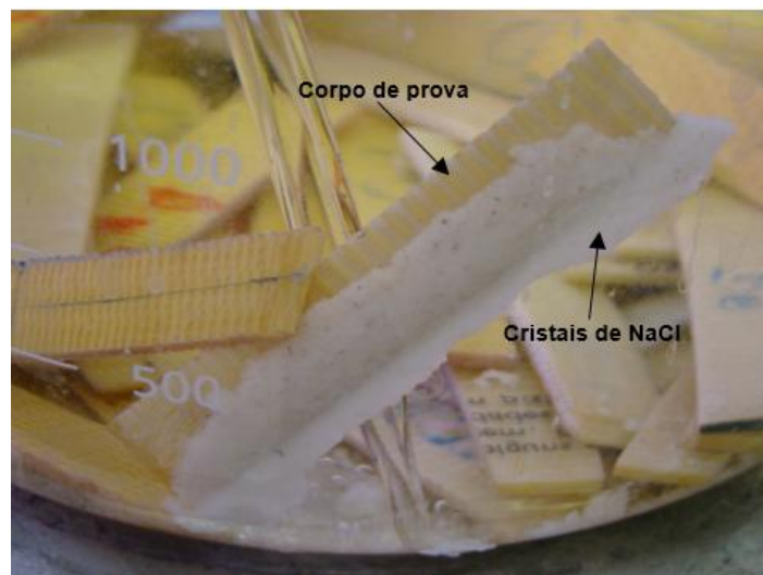
Figura 39 – Fotografia do corpo de prova do compósito B após 30 dias de imersão em água do mar a 70 °C.
