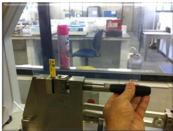
Figura 19 - Corpo de prova no ensaio de impacto.
