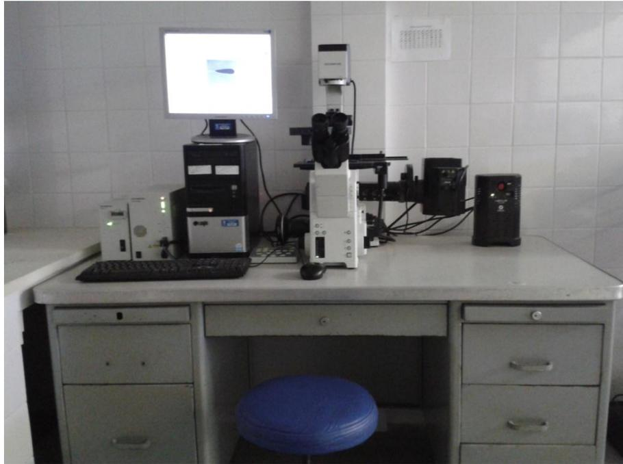
**Figura 15.** Microscópio de fluorescência Axioskop 2 plus, Carl Zeiss, Germany
