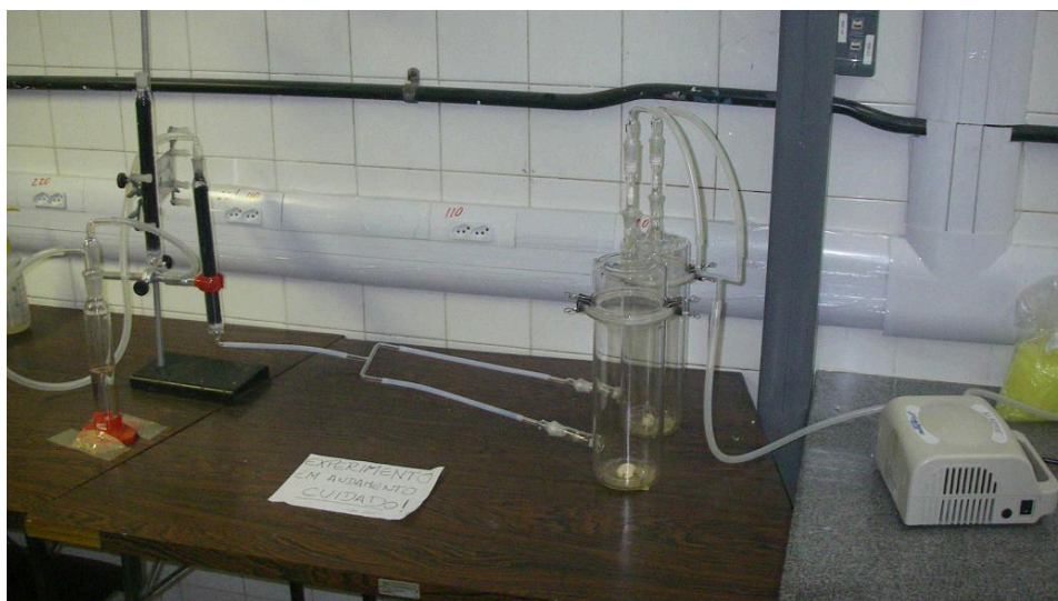
Figura 05: Sistema de aeração para coleta de voláteis, com bomba de vácuo, câmaras de vidro contendo machos e fêmeas de Atheloca subrufella isolados, colunas com polímero adsorvente, filtros de carvão ativado e água destilada.
