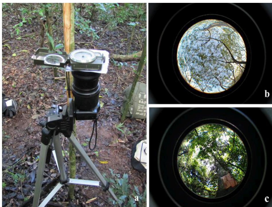
Figura 6: Medição da luminosidade com auxílio de uma câmera digital acoplada a uma lente “olho de peixe”, direcionada para o Norte magnético com auxílio de uma bússola, próximo ao hospedeiro amostral (a). Foto reproduzida pela lente “olho de peixe” em um ponto da área da Caatinga (b) e outra para o Brejo de Altitude (c).
