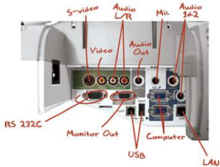
Figura 3 – Painel de conexão da LDI Epson BrightLink® 450Wi
