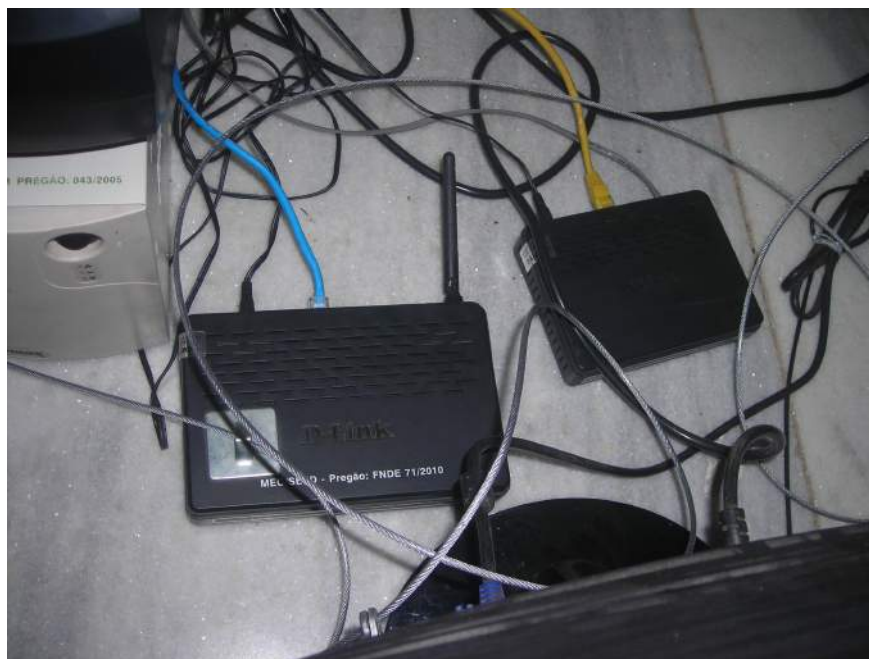
Figura 30 – Detalhe do circuito MEC (modem e roteador wireless ) na EMEF Juscelino Kubitschek
