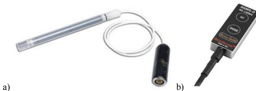
Figura 21. Detectores de radiação a) Câmara de ionização tipo lápis modelo 10x6-3CT-Radcal e b) Detector de estado sólido AGMSD (RADCAL, 2012)
