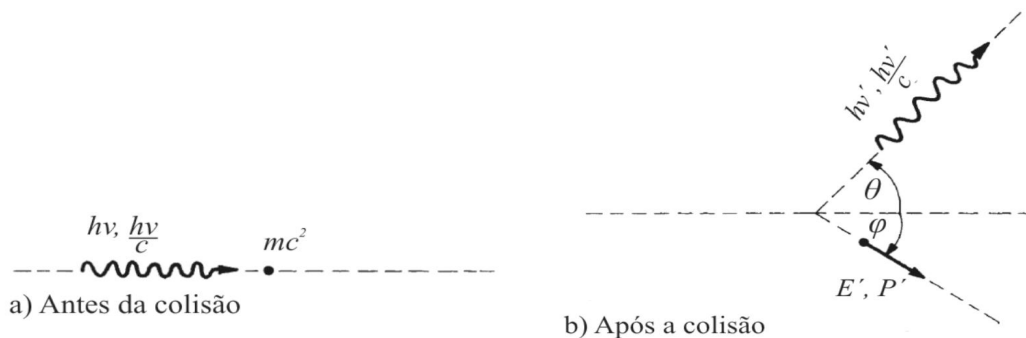
Figura 3. Representação do efeito Compton: a) antes da colisão e b) após a colisão (adaptado de TURNER, 2007).
