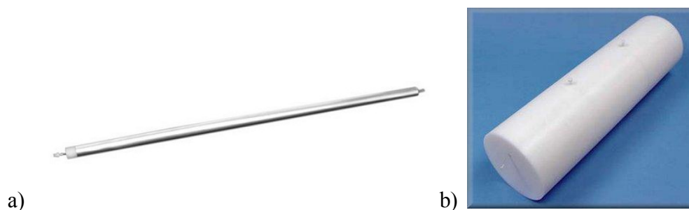
Figura 18. Modelos de simuladores complementares recomendados pela norma NEMA NE 2-2007: a) Para determinação da sensibilidade; b) Para determinação da fração de espalhamento, tempo morto e contagem aleatória (NEMA, 2007).
