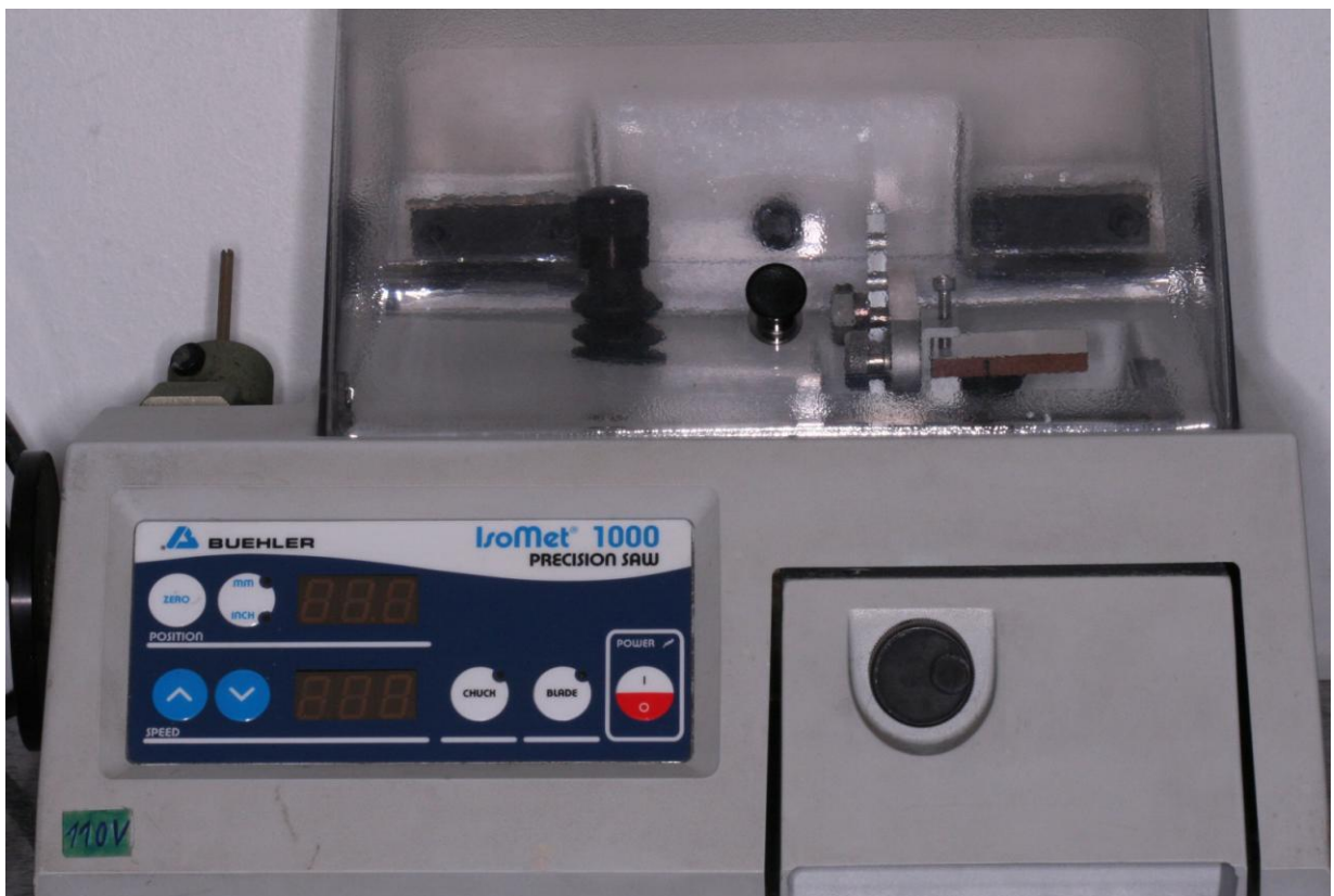
Figura 1: Cortadora Metalográfica utilizada no corte dos dentes para confecção das amostras.
