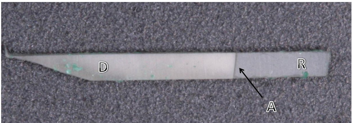
Figura 11: Corpo de prova em forma de palito com espessura de aproximadamente 0,49 mm 2 , com os substratos identificados com as letras R (Resina Composta), D (Dentina) e A (Interface de União).
