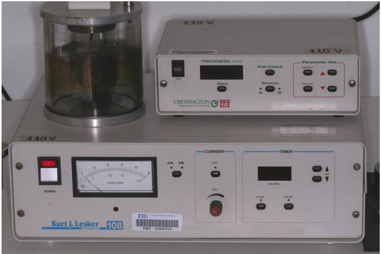
Figura 13: Aparelho metalizador (sputtering) e auxiliar para aferição da espessura do ouro que é depositado sobre a amostra.
