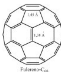
Figura 3: Estrutura do fulereo C60. Fonte: Santos et. al. (2010).
