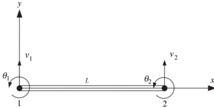
Figura 6. Exemplo de elemento de viga com 4 graus de liberdade.
